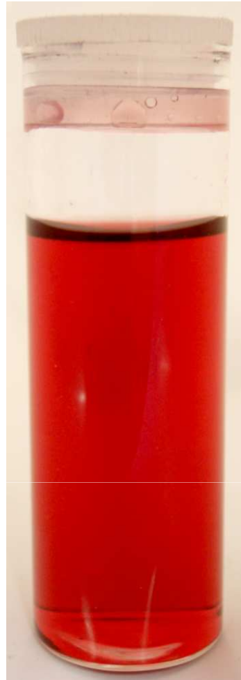
Rys. I.15. Nanocząstki złota otoczone przez molekuły cytrynianu sodu w zolu. Cytrynian sodu posłużył jednocześnie jako czynnik redukujący kwas chlorozłotowy H[AuCl_4] do metalicznego złota.
